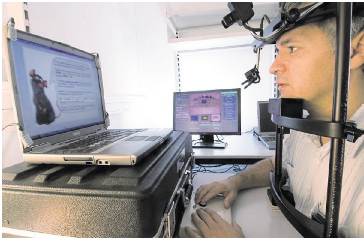
Les trois caméras d'Eyelink, mis au point par le CNRS, suivent l'œil à raison de 500 images par seconde.
