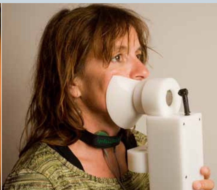
La station d'évaluation vocale assistée a été conçue pour l'étude de la plupart des paramètres de production de la parole. (Photo CNRS - Phototèque/Kaksonen)
